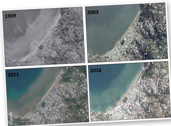
Disparition de la plage au Sud de Sada en raison de l'enrochement.
